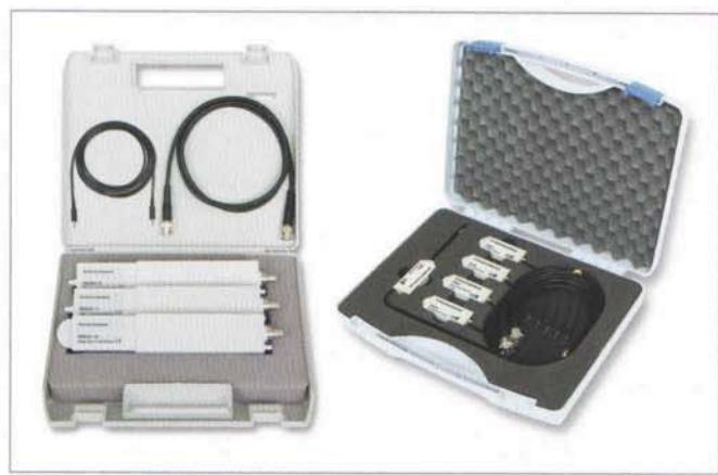
LISN将干扰信号从被测设备耦合到测试设备，同时，在所要求的频带内提供稳定和标准的阻抗。实际的测量电压值受到被测件的源阻抗和LISN的负载阻抗的比值影响，如果LISN阻抗不稳定，在不同的测试地点，测试同一产品，其测试结果的重复性和再现性就会受到影响。
