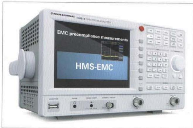
罗德与施瓦茨公司预测试EMI测试解决方案的用途：依据企业内部或者民标/军标进行传导和辐射EMI测量。这些解决方案能够在产品设计和研发的初期，给元器件，模块，和设备制造商提供有效的帮助，使研发人员可以提前采取相应的措施避免以后重复进行昂贵的认证测试。多样的测试能力，高精度和快速的自动测量模式使得这个解决方案成为研发实验室的首选。
